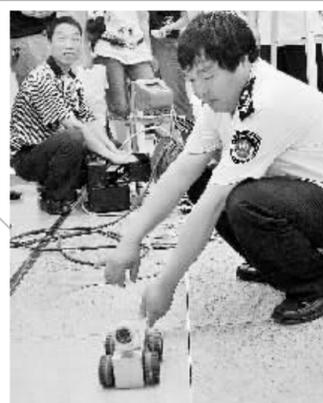
昨日,郑州市卫生监督所专门请来机器人,在二七路某大型商场对中央空调风道进行检查。据介绍,我市正申请购买这种机器人,以便完成中央空调风道内部检查等人工无法进行的工作。本报记者 汪静文 摄
