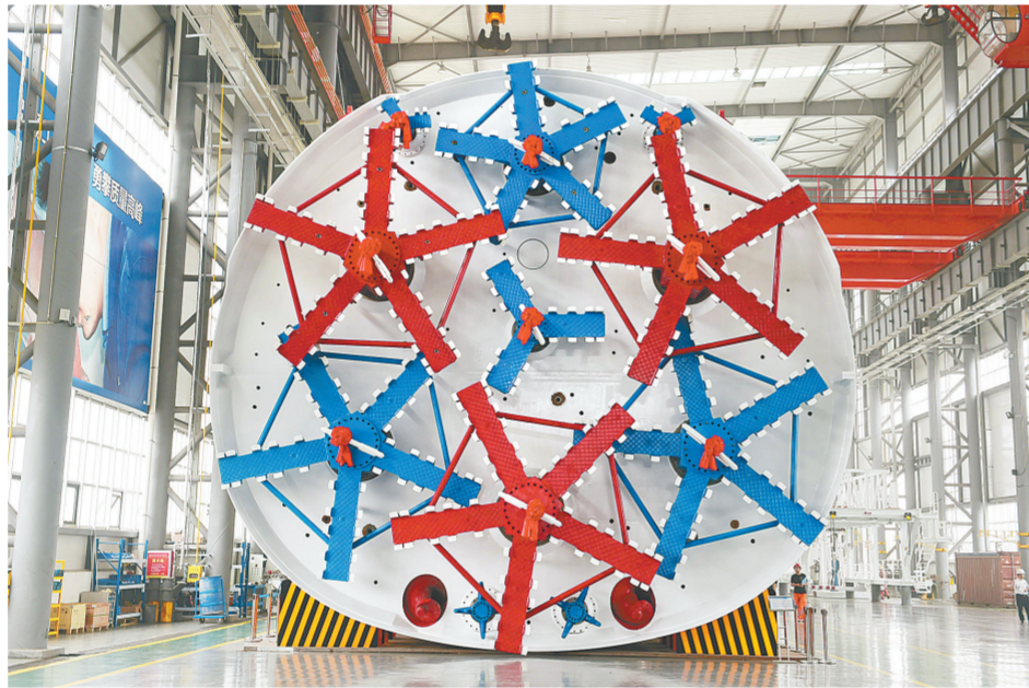
7月17日，全球首台“马蹄形”刀盘盾构机郑州问世(资料图片) 新华社发
