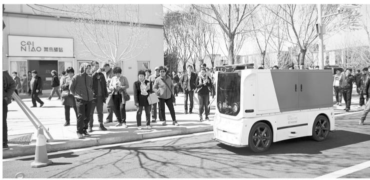
3月31日，由菜鸟网络自主研发的新能源快递无人车在河北雄安市民服务中心投入使用。据介绍，该无人车一次最多可以装载200多个小型包裹，完成从驿站到智能柜的快速接驳运输，能感知周边环境，对行人、车辆等各类动态、静态障碍物避让。新华社发
