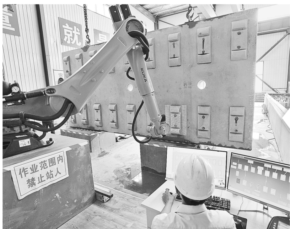
6月17日,一名技术人员通过轨道板自动化检测系统对高铁CRTSⅢ型轨道板进行检测。近日,经智能机器人检测合格的本15000块高铁CRTSⅢ型轨道板在京沈高铁京冀段北京密云巨各庄制板厂下线,标志着我国高铁轨道板自动检测技术达到国际先进水平。该检测系统可使每块轨道板检测时间由40分钟以上缩短至6分钟,检测精度达正负0.15毫米,完全满足高铁建设规范要求。新华社记者 鞠焕宗 摄
