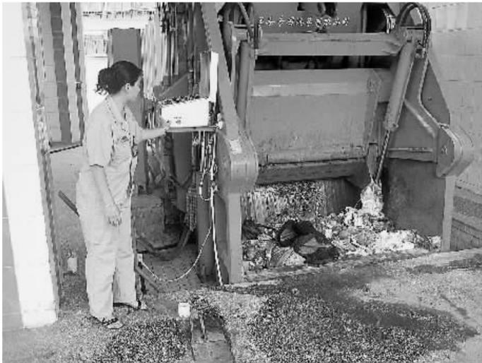
本报讯(记者 靳刚 通讯员 李亚珊 文/图)中原区市政管理局在局属垃圾清运公司深入开展了生活垃圾压缩分流工作,并在全市率先实现了散装生活垃圾全部压缩出城。昨天上午,记者在汝河西路垃圾中转站看到,大型垃圾的车将其他地方的垃圾运到这里,倾倒入一个铁箱子内,然后用专用机器对垃圾进行压缩,这个铁箱子是活动的,可以直接装运到车上拉走,当里面的垃圾不能再压缩时,就可以用专门的车辆将其拉到市外的垃圾场中倒掉。目前,中原区共有垃圾中转站22座,日处理垃圾700余吨,其中普通垃圾中转站7座,压缩式垃圾中转站15座。据在这里的工作人员介绍说,平时的三轮车垃圾在这里可以压缩为一车,工作效率提高了三倍,在全市率先实现了生活垃圾压缩出城的清运模式,极大地节约了运输成本,降低了车损油耗,减少了车辆多次往返垃圾场的次数。
