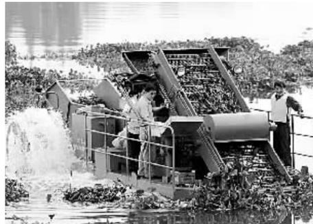
9月7日，漂浮物清理船在浙江金华的一处水面上打捞水葫芦。据介绍，船只经过水面，大片水葫芦被吸进机器，待被粉碎、挤干水分后装入船舱。整个操作只需2至3人，1小时可清理水葫芦18吨左右。
