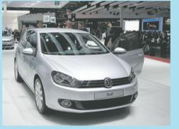
本届车展亮相的第六代高尔夫采用了PQ36平台,其技术与结构基本沿用了PQ35平台已有的先进技术,底盘采用前麦弗逊式独立悬挂与后多连杆式独立悬挂的组合,具有极佳的操控品质与行驶舒适性,激光焊接与高强度的车身结构也得以全面继承。
