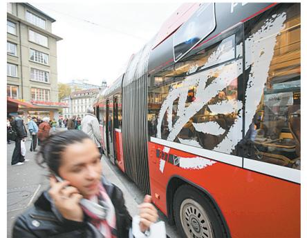
10月27日,一辆带有树叶标志的公共汽车在瑞士首都伯尔尼市中心运营。这种公共汽车的能源来自污水处理厂利用污水沉淀而成的污泥所产生的沼气,使用成本比柴油低40%,有害气体排放量也更低。目前,伯尔尼市三分之一的公共汽车已经采用这种清洁能源。新华社发
