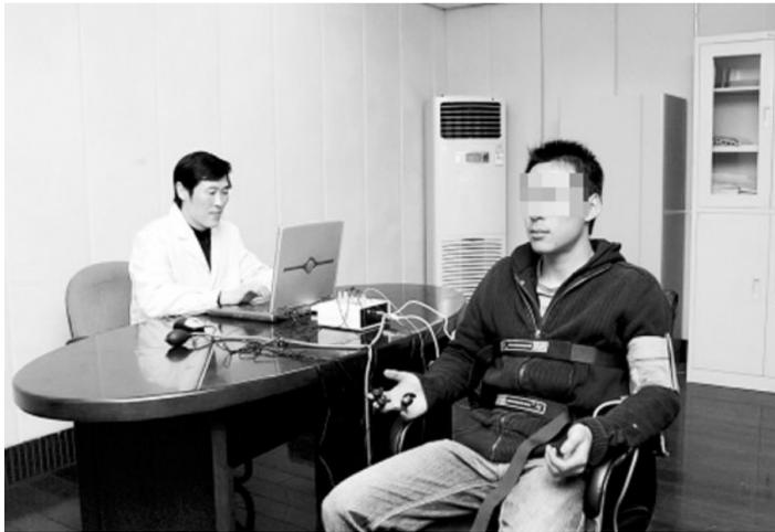
个是系在人的胸部的呼吸传感器,用来测量人的呼吸变化;还有一个是戴在手腕和臂部的脉搏血压传感器,用来测量脉搏和血压的变化。主机的作用是将传感器所采集的模拟信号经过处理转换成数字信号,输入计算机进行存储、分析。
