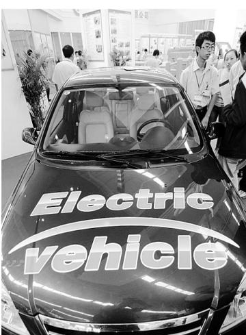
由哈尔滨哈飞汽车工业集团有限公司研发的纯电动汽车9月1日亮相沈阳第八届中国国际装备制造业博览会。这辆锂离子纯电动汽车,最高车速可达到每小时130公里,20分钟就可以快速充电80%,一次充电续航里程达到180公里,基本性能与汽油车持平。新华社发
