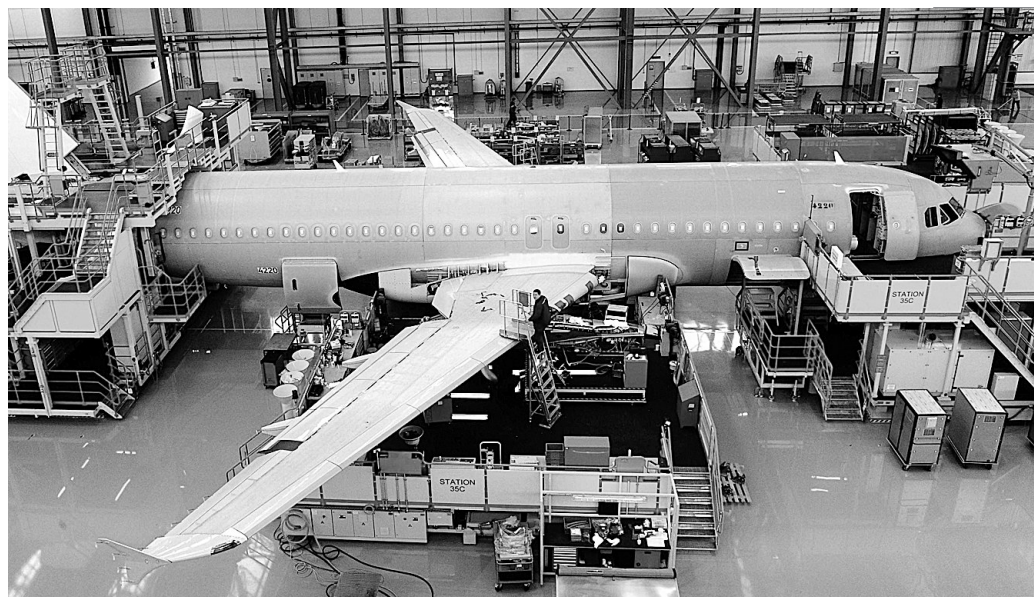
3月16日,由中国航空工业集团公司下属西安飞机工业集团有限责任公司完成总装的首对空客A320机翼在空客天津总装厂成功实现与机身对接。机翼质量及制造水平获得了用户的肯定。图为由中航西飞总装的首对空客A320机翼被装配在机身上。新华社发
