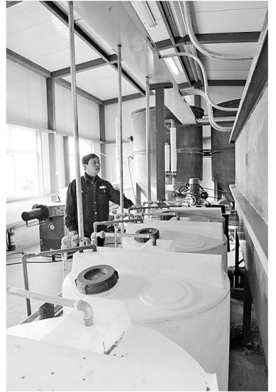
昨日,记者在荥阳四维机电制造基地了解到,该企业节能减排建设成效显著。据了解,他们采用闭路循环、低铬钝化和二级喷淋净化装置以及增设垫料的铬雾回收器等先进的工艺建成的电镀车间生产线,不仅杜绝了含铬清洗水的排放,而且每天可减少5吨水的排放,成为目前我省设施最先进、工艺最合理、环保最优秀的生产线。 本报记者 许大桥 摄
