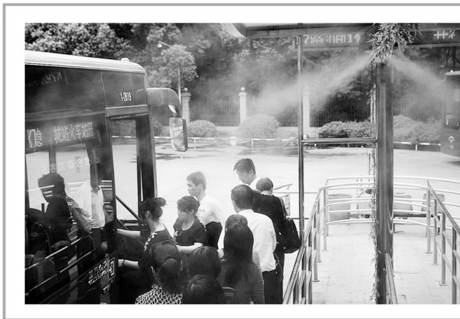
近日，浙江杭州市灵隐公交中心站启用“喷淋降温系统”，在国内首次试点将该系统应用于公交运营服务。该系统将水进行雾化处理，达到降温、净化空气、除尘、保湿等效果。系统运行时，喷雾喷到的范围内，气温能降低5摄氏度以上，给候车乘客送去一片清凉。
