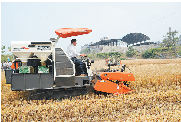
昨日,两种履带式新型收割机在巩义推广使用。这种收割机转弯灵活,可360度调头,适合山区和泥地作业,能有效收割低矮、倒伏的谷物等。
