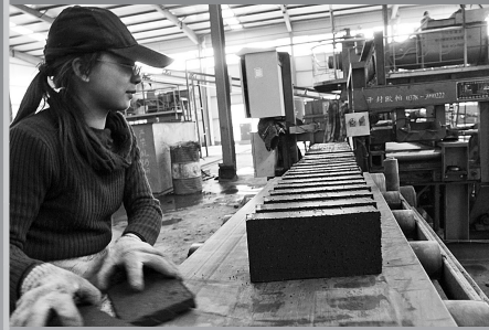
煤矸石砖生产项目采用循环窑烧砖工艺,利用煤矸石燃烧制砖,该项目的建成投产拉长了煤炭产业链条,对于辛店煤炭循环经济发展具有十分重要的意义。
