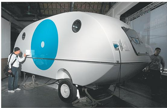
12月8日,避难露营水陆两用拖车“现代方舟”在台北举行产品发布会。“现代方舟”的车体结构与豪华游艇同等,外壳由两块完整的玻璃纤维组成,加装空气过滤器与防核污水过滤系统,同时拥有柴油发电、太阳能发电、风力发电三种电力系统,在灾难来临时可成为临时避难舱。目前“现代方舟”已在大陆和台湾上市。
