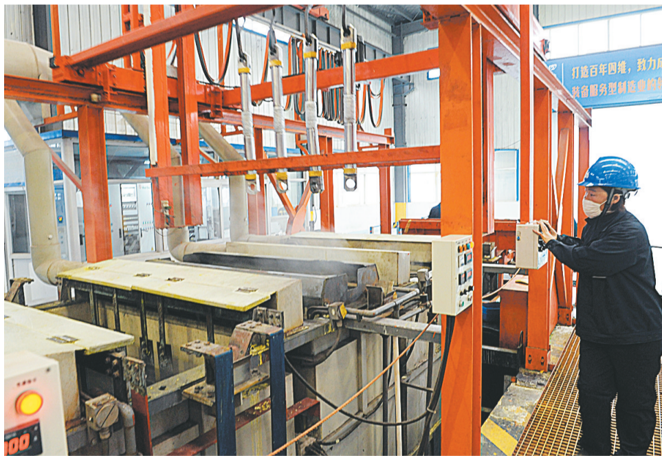
“我们现在使用的电镀生产工艺实现了污水零排放,度铬零污染标准,技术达到了国内先进水平。”昨日,郑州四维机电设备有限公司电镀车间工程技术人员对记者介绍说,四维公司注重对新技术、新产品的研发投入,从2008年至今,投资近两亿元自主设计开发采煤机、运输机、液压支架等40项以上,获国家授权专利达70多项。 本报记者 许大桥 摄
