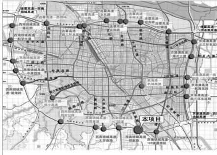
现郑州市交通运输委员会，正在办理郑新快速通道与西南绕城高速公路互通式立交新建工程的《建设工程（交通）规划许可证》，项目位于郑州市东南部，省道S102（郑新快速通道）和西南绕城高速公路交汇处。项目改建西南绕城高速公路1100米，改建郑新快速通道820米，新建匝道3082米，加宽西南绕城高速公路桥梁117.99米/2座，新建匝道桥174.95米/4座，涵洞4道，通道4道，设4进7出收费站1处。
