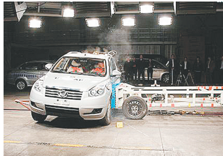
图为进行可变移动壁障侧面碰撞试验
