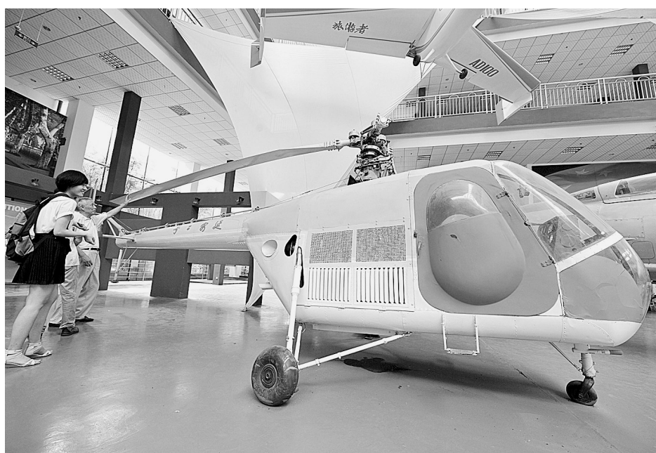
7月18日,南京航空航天大学向媒体展示了该校收藏的我国第一架自行设计制造的直升机“延安二号”。“延安二号”轻型直升机于1965年开始研制,1967年进行总装并开始地面试车,1975年在南京东山机场试飞成功,首次完成了我国独立自主研制直升机的全过程。“延安二号”当年共设计了3架,一架已用于静力实验,另两架目前收藏于南京航空航天大学,其中一架被改造为教学试验设备。
