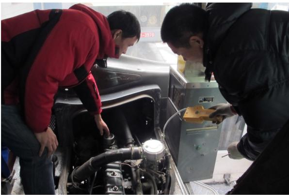
为保障乘客安全乘车，公交一公司组成安全检查小组对公司所属各线路车辆组进行拉网式检查，对发动机减压舱等进行逐一检查登记，要求存在隐患的车辆立即停止运营回场检修。本报记者 宋晔 摄
