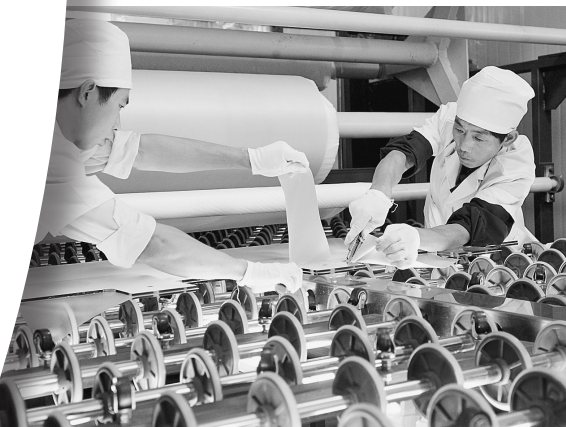
河南福鑫玻璃有限公司的工人正在生产防弹玻璃。
