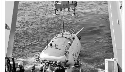
7月3日,在南海执行首个试验性应用航次的“蛟龙”号载人潜水器在“蛟龙海山”下潜,这个潜次是科学下潜,主要目的是到海山区提取岩石等样本,并进行海底地形测绘与测量。这次是“蛟龙”号首个试验性应用航次的第6次下潜。
