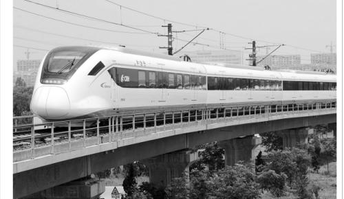
7月3日,我国首列公交化时速160公里CRH6F型城际动车组在中国南车青岛四方机车车辆股份有限公司竣工下线,该动车组具有载客量大、快起快停、快速乘降、频繁起停的技术优势,是为适应我国新型城镇化建设需求、构建1小时经济圈而研制的新型快捷轨道交通工具。
