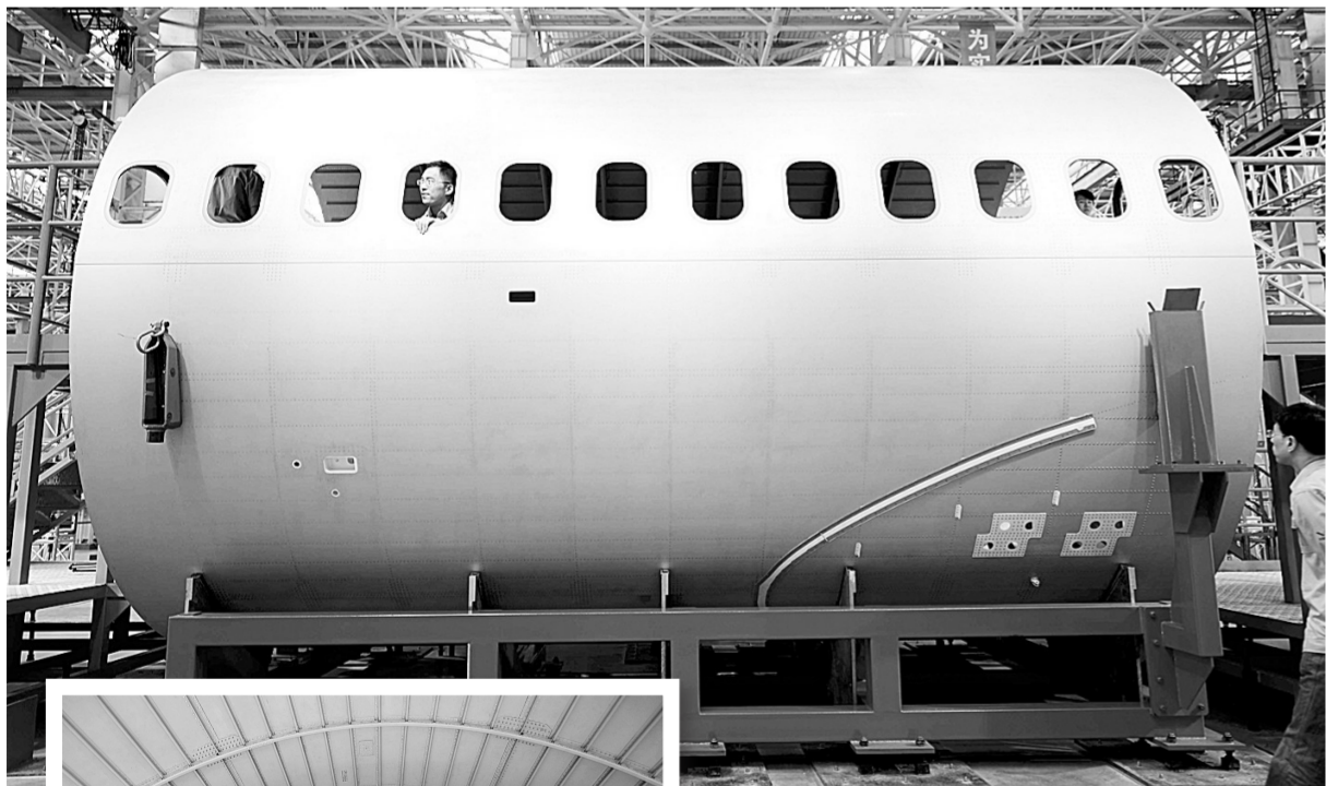
上图是5月15日拍摄的C919大型客机铝锂合金前机身大部段外观。
