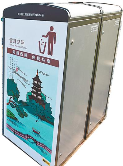
2月7日,十组贴有西湖十景绘画的太阳能智能压缩垃圾箱亮相杭州西湖白堤。据介绍,垃圾箱通过不同投放口进行垃圾分类引导,内部设有压缩系统,用箱顶的太阳能电池板供电,可自动对投入的垃圾进行压缩。
