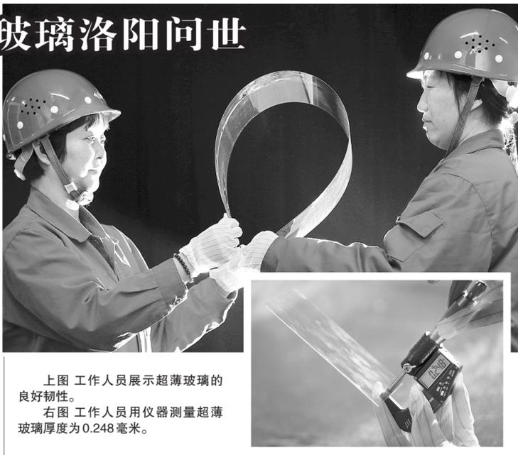
上图 工作人员展示超薄玻璃的良好韧性。 右图 工作人员用仪器测量超薄玻璃厚度为0.248毫米。
