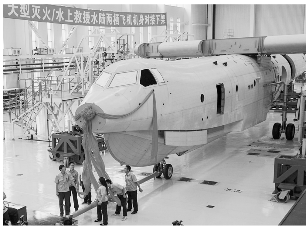
已在珠海完成机身对接的大型灭火/水上救援水陆两栖飞机正在移动至总装区域(7月17日摄)。新华社记者 魏蒙摄
