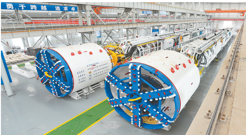
中铁装备盾构机组装车间
