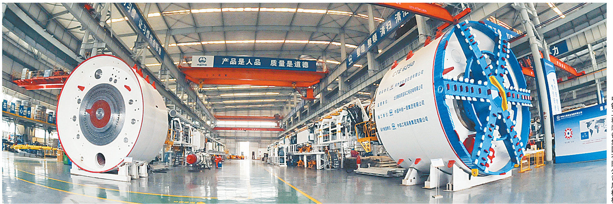
中铁工程装备集团有限公司盾构机
