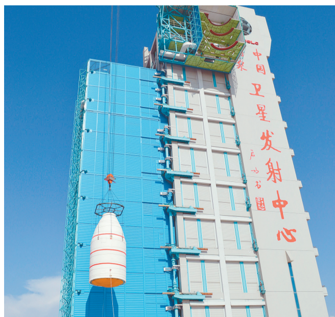
酒泉卫星发射中心,星箭组合体吊装,与运载火箭对接(8月5日摄)。新华社发
