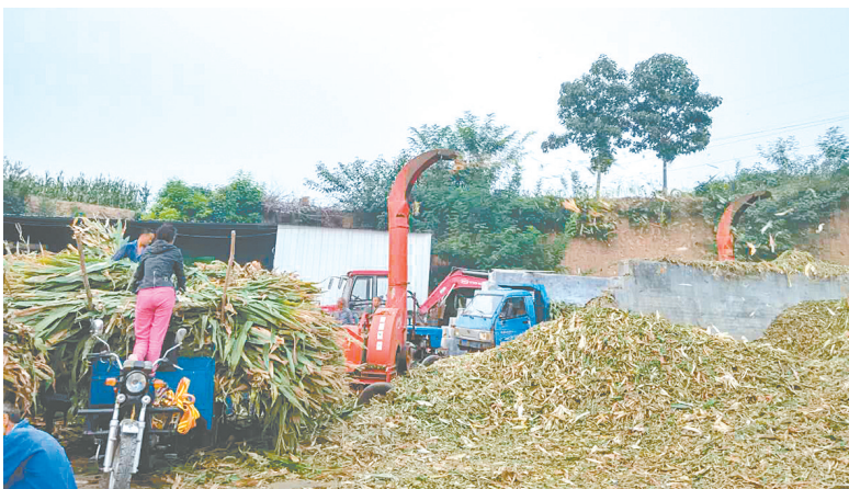
秸秆青贮机将“吃”进的整棵玉米秸秆“嚼碎”后吐出
