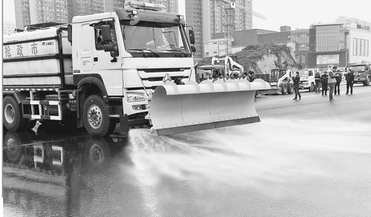
本报讯(记者 裴其娟 通讯员 李冬菊文/图)昨日,郑州市政工程管理处组织16支抢险队、近百名抢险专业人员、30余台除雪设备,在新修通的东风西路开展清除冰雪演练。其中,一台液态融雪剂洒布车首次亮相。该车可在中小雪天气使冰雪就地融化,经雨水管道排放。据了解,今年,市城管局共采购液态融雪剂洒布车20台。
