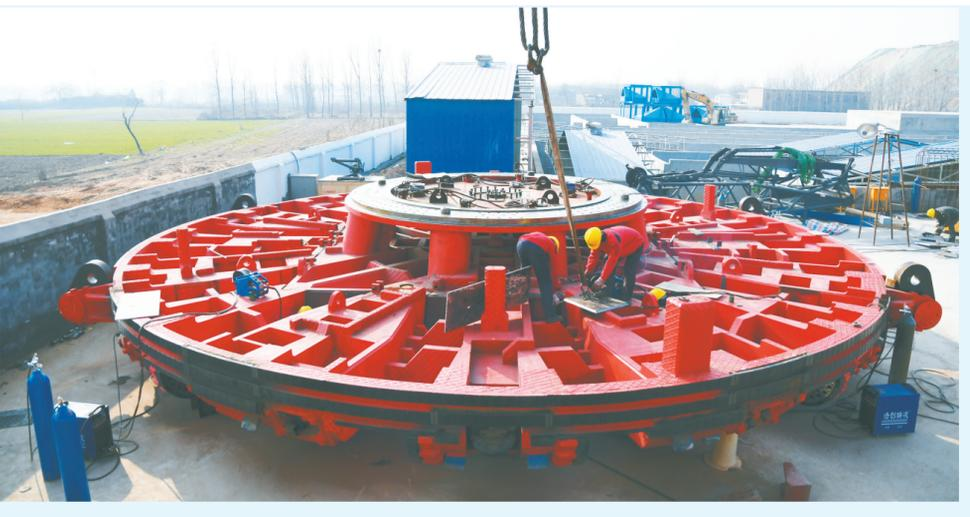
本报讯(记者 成燕文 李焱图)吊车摇臂,火花四溅,机器轰鸣……昨日,在位于航空港区的中铁十六局集团豫机城际铁路工程一标段项目部施工现场,记者看到,几位焊工正在对一个直径达12.81米的盾构机刀盘进行焊接。这个堪称我省境内施工现场直径最大的“巨无霸”刀盘,在完成焊接、盾构机主体安装后,国产首台铁路单洞双线大直径盾构机“中原一号”将于明年元旦前启用,届时,由我省主导建设的首条城际铁路项目——豫机城际铁路工程地下掘进将全面启动。
