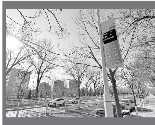
12月14日,北京左安门西街的新型复合路灯杆监控系统正式上线,显示屏上显示着各种数据信息。当日,20根复合路灯杆亮相北京左安门西街,其中18根具备电动汽车充电桩功能,另外2根具备视频监控、wifi基站、信息发布等多种功能。据了解,未来在北京城六区试点路段将完成100根这样的复合路灯杆建设。新华社发
