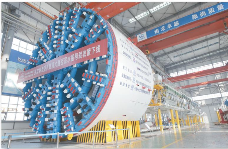
昨日,中铁装备首台超大直径泥水盾构——中铁297号在郑州顺利下线。据了解,该设备将用于京沈客专望京隧道项目,盾构开挖直径为10.90米,这也是中铁装备又一台投入铁路隧道工程的盾构设备,它的下线标志着我国高端装备在大直径泥水盾构制造领域迈出了关键的一步。 本报记者 张倩 通讯员 陈龙 摄影报道
