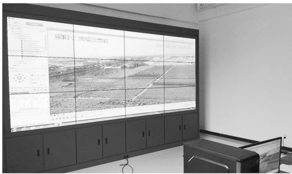
在50米高的通信基站铁塔上安装高清摄像头,方圆12平方公里内只要拍到有人焚烧秸秆、垃圾,系统就会自动判断并报警,工作人员就会及时到场核实处置。这是该市正在实施的“蓝天卫士”工程依托河南移动与华为公司联合开发的“千里眼”视频监控平台所能达到的效果。摄像头结合云计算和互联网技术,实现了全天候防控。
