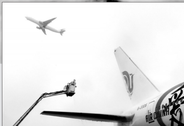
上海虹桥机场的地勤人员为大型客机除冰雪,减少航空器滞留时间。
