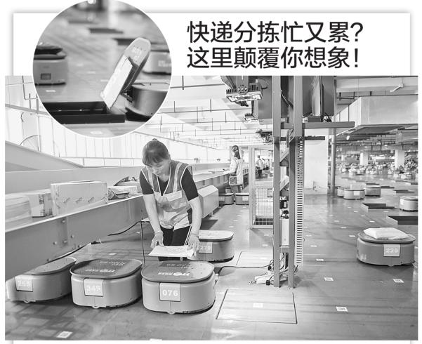
9月14日,阿里巴巴旗下物流平台菜鸟网络与圆通速递联合开发的超级机器人分拨中心在圆通速递杭州转运中心正式启用。据了解,高峰期时,在约2000平方米的场地内,超级机器人分拨中心350台机器人昼夜作业,每天可分拣超过50万个包裹。图为工作人员将包裹交给机器人进行自动化分拨。 新华社发
