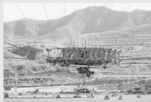
11月14日拍摄的火星探测任务着陆器悬停避障试验现场 新华社记者 金立旺 摄
