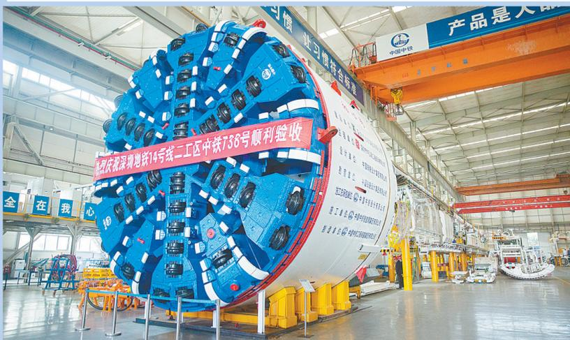
本报讯(记者 张倩 通讯员 孙凯笛 文/图) 昨日,记者从中铁工程装备集团了解到,由深圳地铁集团、中铁工程装备集团、西南交大联合研制的国内首台采用中心螺旋出渣模式的土压/TBM双
