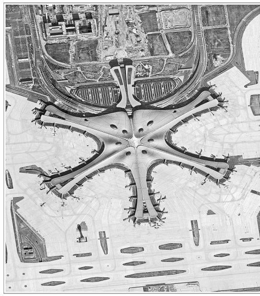
这是分辨率为0.65米的高分七号卫星北京大兴国际机场真彩色融合正射影像
