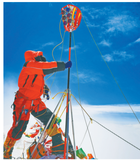
2020珠峰高程测量登山队员在珠穆朗玛峰峰顶开展测量工作(5月27日摄)。据自然资源部第一大地测量队队长李国鹏介绍,本次测量同时参考四大导航系统,并以北斗的数据为主。 新华社特约记者 扎西次仁 摄
