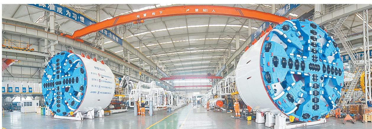
中铁装备有限公司盾构机生产线。
