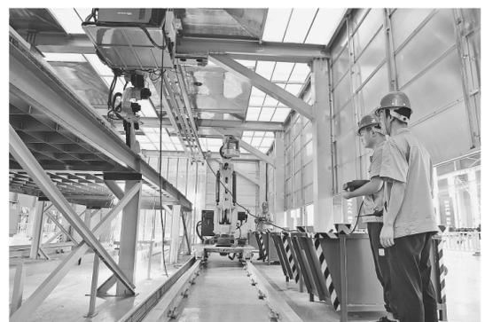
在报废货车拆解生产线上,机器人手臂对车厢进行拆解(5月26日摄)。
