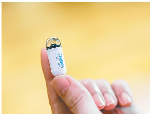
9月24日，工作人员现场展示RC100全自动导航胶囊机器人使用的人体吞服胶囊。
