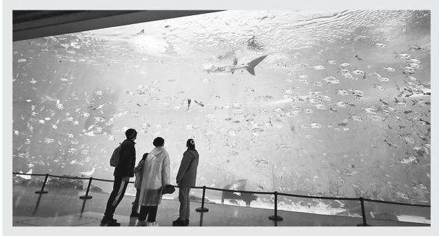
1月26日,游客在上海海昌海洋公园观看仿生鲸鲨。当日,一条仿生鲸鲨在上海海昌海洋公园下水,正式与游客 见面。这条仿生鲸鲨由沈阳航天新光集团有限公司生产,体长近5米,采用锂电池驱动,最大游速0.7米/秒,最大下潜 深度10米。多关节仿生推进技术、浮力调节技术和水下视觉技术的应用,加上表面覆盖的仿生蒙皮,使得仿生鲸鲨能
