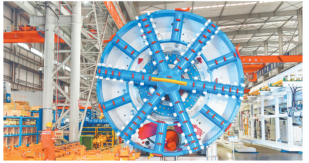
盾构机生产线
