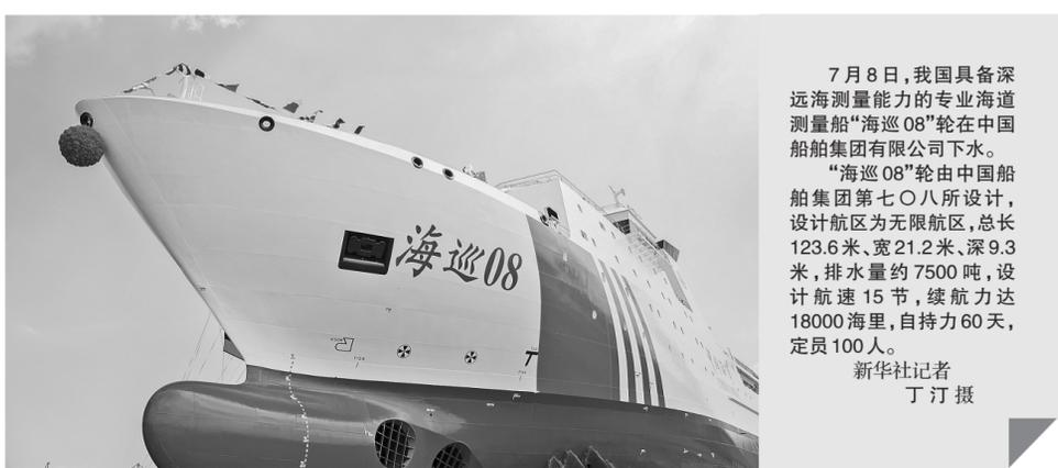
7月8日,我国具备深远海测量能力的专业海道测量船“海巡08”轮在中国船舶集团有限公司下水。“海巡08”轮由中国船舶集团第七〇八所设计,设计航区为无限航区,总长123.6米、宽21.2米、深9.3米,排水量约7500吨,设计航速15节,续航力达18000海里,自持力60天,定员100人。新华社记者 丁丁 摄
