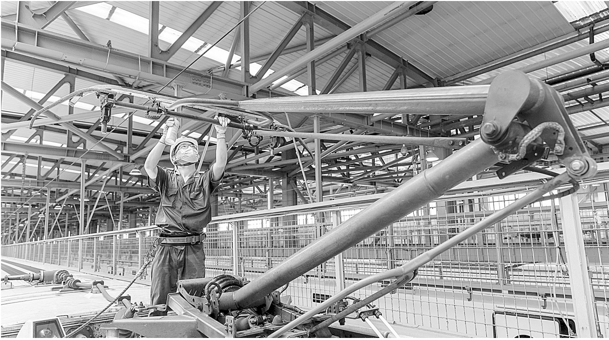
8月10日,动车组机械师对受电弓碳滑板进行漏风试验。暑运期间,上海虹桥动车运用所内一派繁忙。被称为“高铁医生”的动车组机械师对复兴号动车组的“脚”——走行部件、“心脏”——高压牵引部分、“身体”——车内服务设施等进行细致检修和维护,确保暑运期间列车运行安全。
