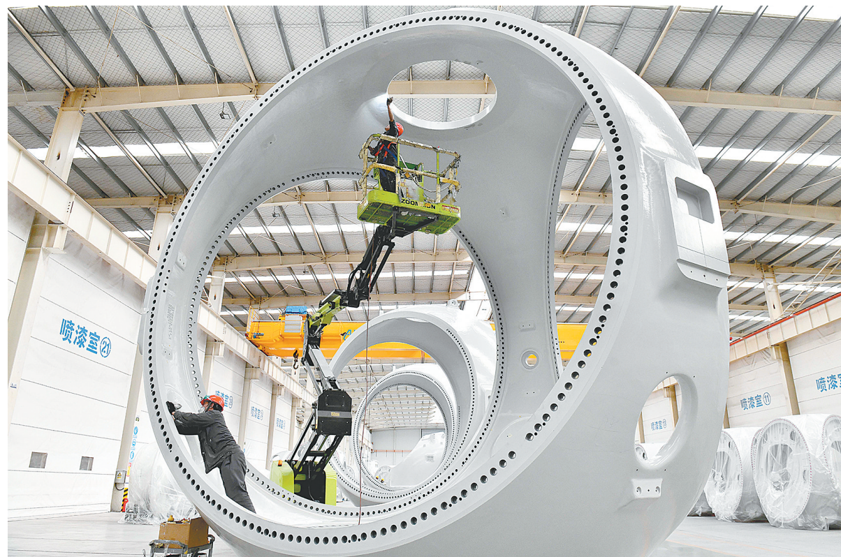
在山东省惠民县风电装备产业基地涂装车间，工作人员对风电轮毂进行涂装(6月7日摄)。 新华社发
